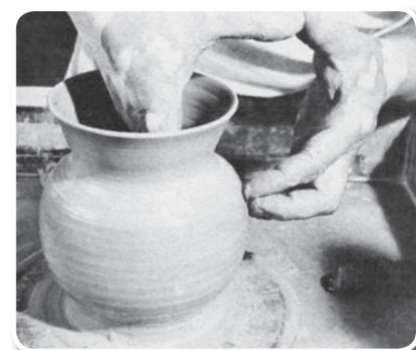
Gambar 3.7 Membuat gerabah dengan teknik putar Sumber: Ceramics , 1985
