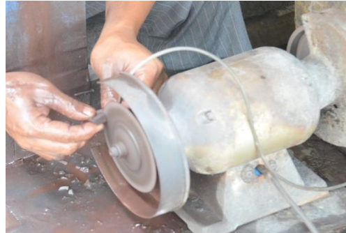
Gambar 43. Proses Pemotongan Batu Permata Menggunakan Mesin Potong Listrik Yang Dilakukan Oleh Seorang Pengrajin
