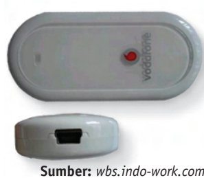
Gambar 2.15 Modem GSM untuk akses wireless Internet .
